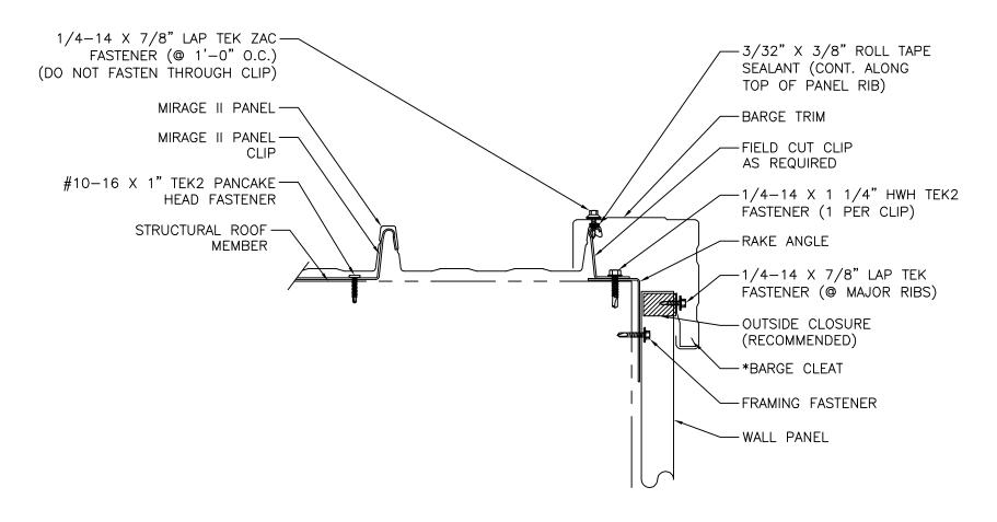
\*NOTE: THERE IS NO BARGE CLIP FOR THE 5" BARGE TRIM. INSTALLER MUST USE BARGE CLEAT AS SHOWN IN DETAIL. WHEN USING 7" BARGE TRIM, INSTALLER MAY USE EITHER BARGE CLEAT OR BARGE CLIP.
