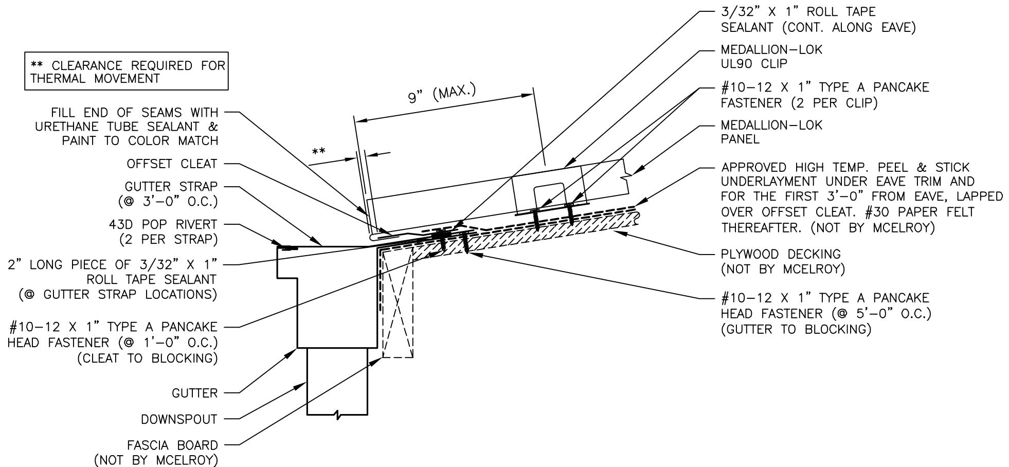
\*NOTE: SLIDING SNOW AND ICE COULD CAUSE DAMAGE TO GUTTER SYSTEM.
